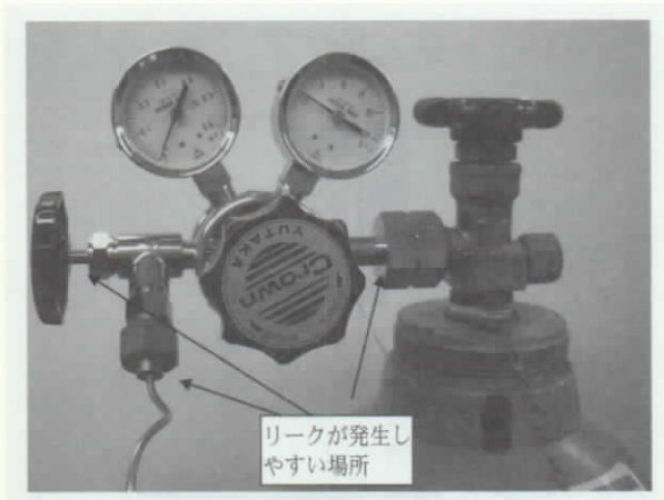
図1 減圧弁でリークが発生しやすい場所
