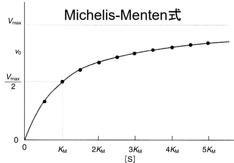
図 14・8 簡単なミカエリス・メンテン反応の初速度  $v_0$  と  $[S]$  の関係
