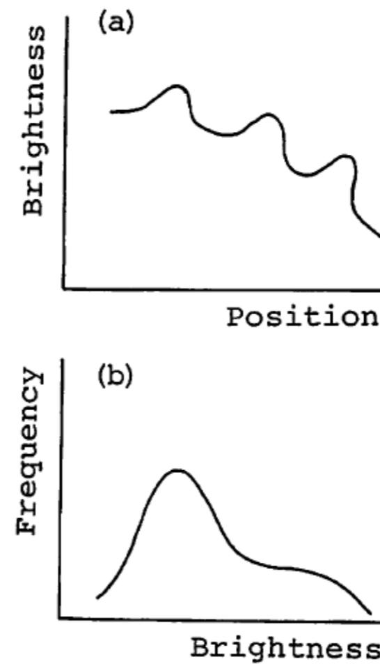
第3図 顕微鏡の視野に明るさむらがある場合の暗視野上の細胞の明るさの分布 (a) と明るさの頻度分布 (b)
