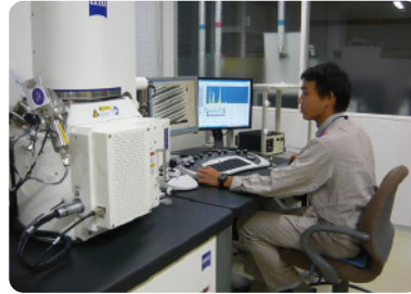
◀ 走査型電子顕微鏡を用いた材料損傷解析 Materials failure analysis using SEM
