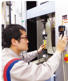
◀ 引張試験機を用いた 高分子材料の強度評価 Strength evaluation of polymeric materials using tensile testing machine.
