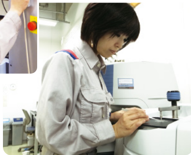
▶ フーリエ変換赤外分光法を用いた 高分子材料の評価 Evaluation of polymeric materials using FT-IR.
