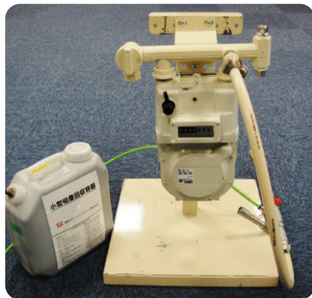
▲ガスメーターの残ガス回収システム Gas adsorption system for residual city gas at meter replacement
