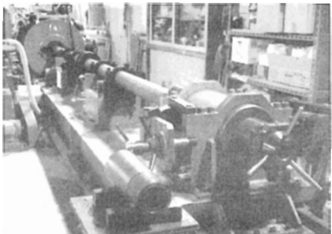
図3: 隕石衝突模擬実験に用いられる一段式火薬銃 (物質・材料研究機構)
