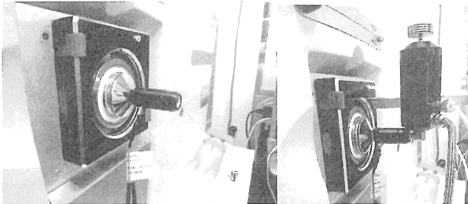
図 1 SICRITイオン源をLTQ Iontrap MS (Thermo)に接続した図
