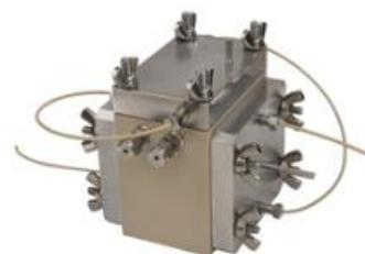
Fig.1 On-lineガス分析用電池セル
