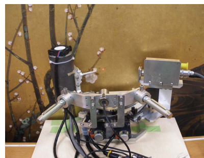
図 ポータブル回折計による 屏風の測定風景
