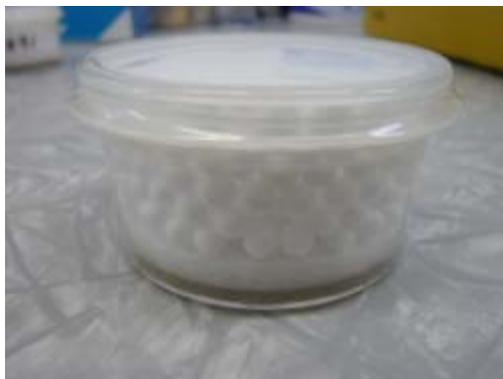
試料 B の篩後 250  $\mu\text{m}$  以上試料の 1 回目粉碎後、篩いデータ
