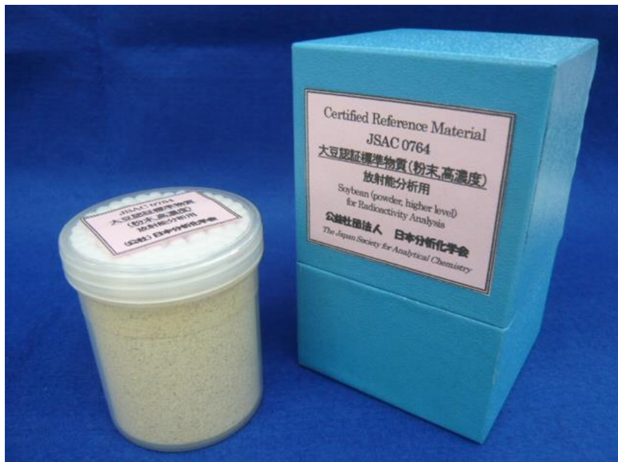
写真1 開発した放射能分析用大豆認証標準物質（粉末状、高濃度）（JSAC 0764）ポリプロピレン製容器（U8）内に、高さが 50 mm になるように充填された標準物質と、梱包の箱。容器上部にみられる白色部分は大豆が移動しないための充填剤です（内容量 75.0 g）。
