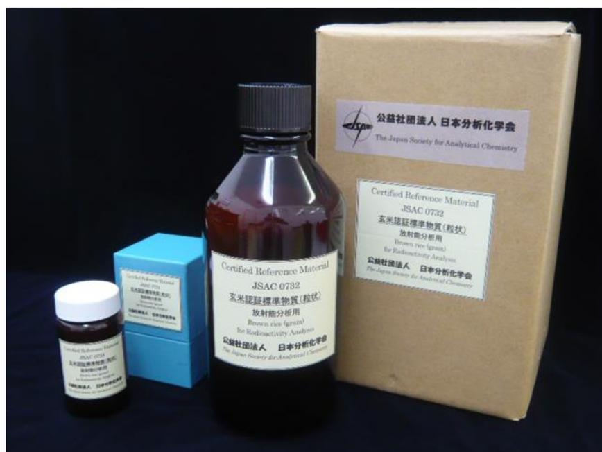
写真2 開発した2種の放射能分析用玄米認証標準物質（粒状）（JSAC 0731 および JSAC 0732）
