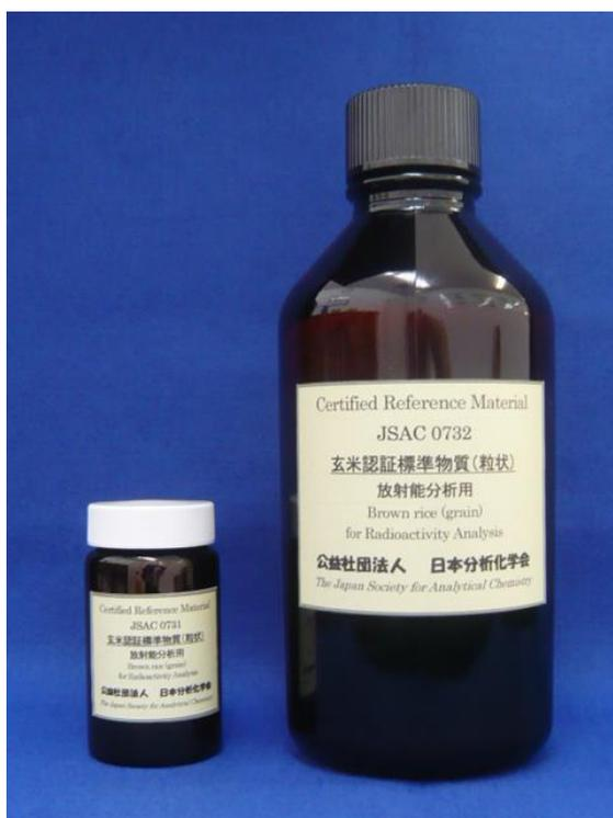
写真1 開発した2種の放射能分析用玄米認証標準物質（粒状）（JSAC 0731 および JSAC 0732）
