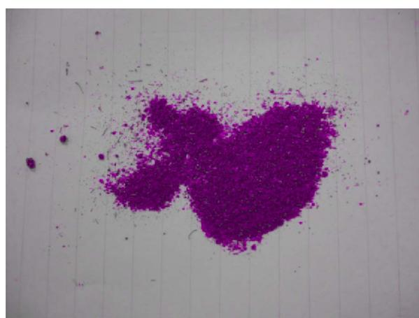
図 7 凍結粉碎後の被覆銅線の一例
