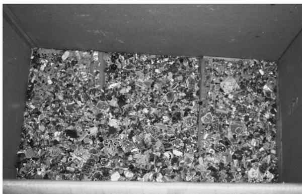
図5 粉砕後の電子基板の一例
