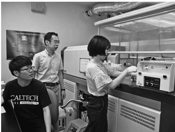
一般的な ICP-MS とは異なり、複数の同位体の信号を同時に検出するため、高精度な同位体比分析が可能である。
