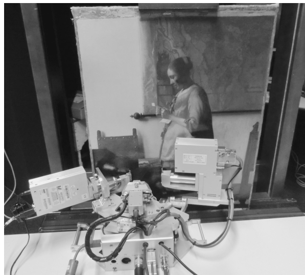
図 1 可搬型粉末 X 線回折装置を用いたフェルメール作「手紙を読む青衣の女」のオンサイト分析の様子
