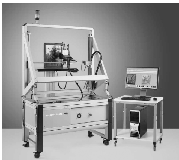
図 2 大型絵画の非破壊オンサイト分析が可能な Bruker 社製 M6 JETSTREAM（装置カタログ 12) より引用）
