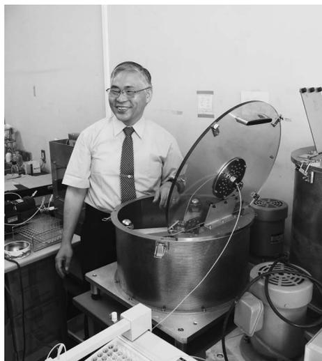
写真2 四宮先生自自作の「小型交軸型 CCC」
