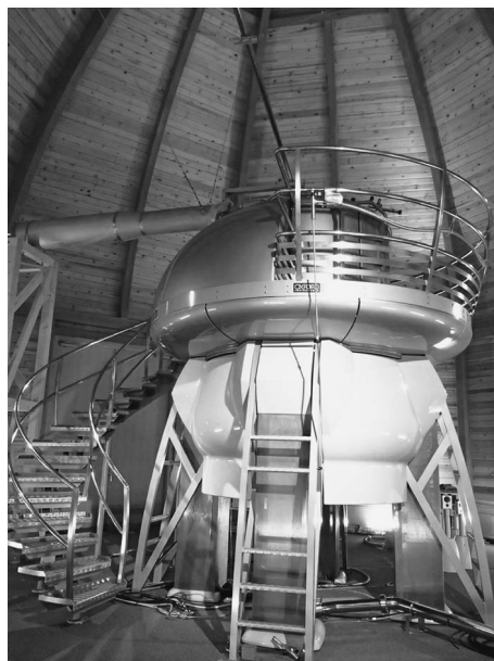
写真 4 ドラマ「ガリレオ」に登場した 900 MHz NMR 装置
