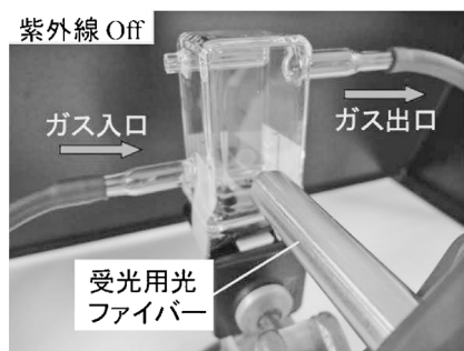
図 2 蛍光 QD 薄膜を格納した石英製ガスセル
