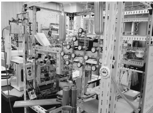
写真3 独自に構築した連続フロー型同位体比質量分析システム
