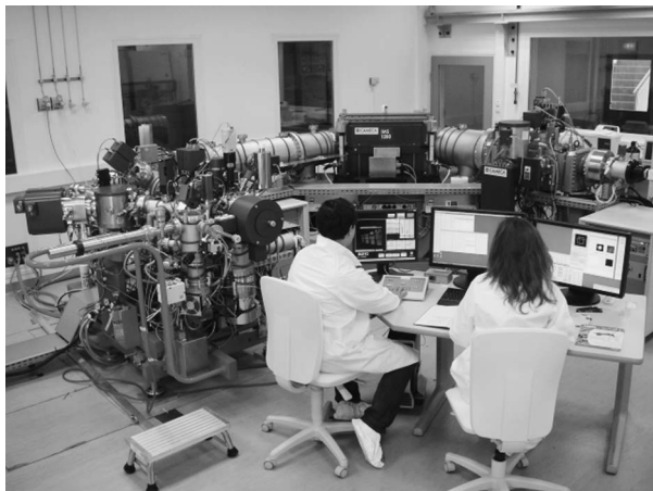
写真5 環境試料クリーンラボ拡張建屋内に新しく設置されたLG-SIMS
