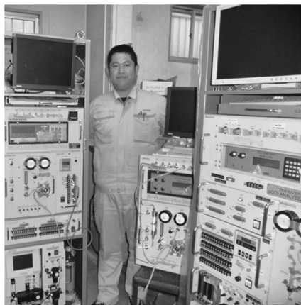
写真5 左が大気・海洋二酸化炭素自動測定装置と海洋の営業担当の木下勝元さん、右が p\text{CO}_2 のタンデム型気液平衡器
