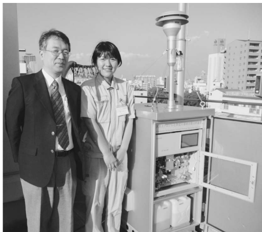
写真1 大気エアロゾル化学成分連続自動分析装置と左から筆者、装置の試運転をしている福永明子さん
