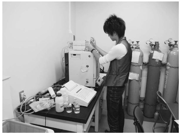
写真3 ガスクロマトグラフ法によって \text{N}_2\text{O} や \text{CH}_4 を分析している学生
