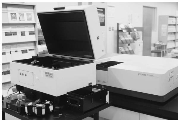
写真4 UV装置（奥）は主に液体用でセルまわりはコンパクトに設計されているため、より大きな試料には専用の試料室（手前）を付属する
