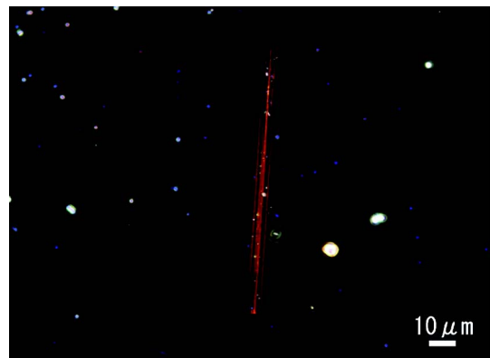
図 16 茶石綿の分散色写真（アナライザー使用，回転 90 度）
