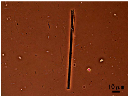
図 11 茶石綿の位相差顕微鏡写真（位相差板装着対物レンズ使用，アナライザー使用）
