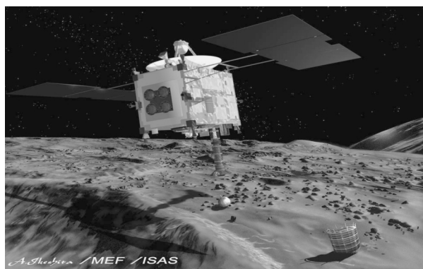
探査機下面にサンプラーホーンが取り付けられている。小惑星表面にある球状物体は着地点を示す人工目標、手前の物体は小型ロボットランダー「ミネルヴァ」。
