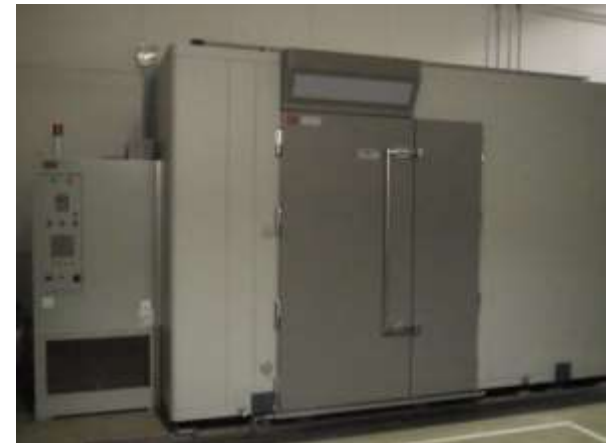
静置室 (恒温恒湿室)
