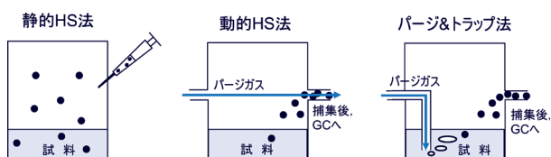
図7 ヘッドスペース法およびパージ&トラップ法の概略図 2)
